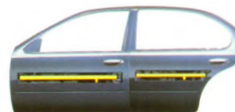
Veiligheidsbalken in de deuren.
