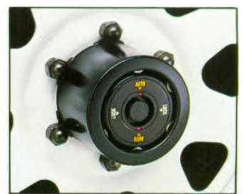
Vrijloopenaven op de vooras welke zowel automatisch als met de hand kunnen worden ingeschakeld.
