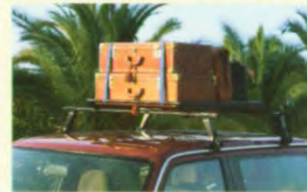
Dakrailing met bagarek en spanbanden.
