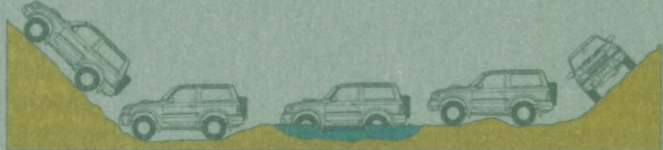
Zijdelingse hellingshoek max. 48° 240 mm 230 mm, achter. Grondspanning voor. 700 mm Doornhoogte 37,5 en 37, voor. resp. 3- en 2-dans. 30 en 31, voor resp. 3- en 2-dans. 39° Klimhoek max. 39°
