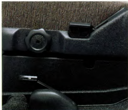
Kantelmechanisme op bestuurdersstoel
