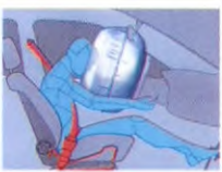
84: gordels en airbag vangen de kracht van de aanrijding op;
