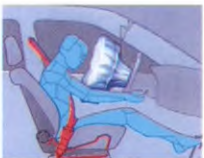
54: airbag is volledig opgeblazen;
