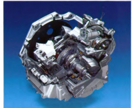
De nieuwe, elektronisch gestuurde 4-traps automatische versnellingsbak van de Astra is uiterst compact en zorgt voor zuinig energieverbruik en soepel rijgedrag.
