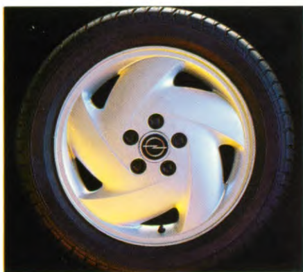
De lichtmetalen 6 J x 16-velgen zijn speciaal voor de Calibra Turbo ontwikkeld en uitgerust met banden in de maat 205/50 ZR 16.
