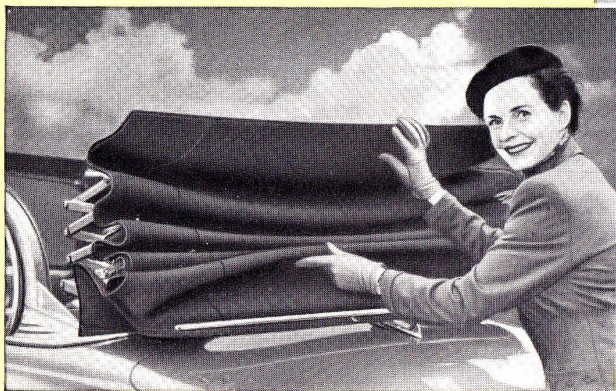
Eenvoudiger en sneller kan het bijna niet; in enkele seconden is de kap over de wagen gelegd en vastgezet: eerst wordt de hoofd-dwarsstang van de kap opgeheven.
