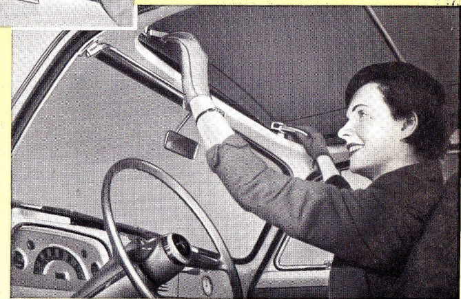
Dan wordt de dwarsstang van de kap boven de achterraut van plexiglas naar voren geschoven. De kap gaat omhoog, valt naar voren en ligt los op de kaplijsten.
