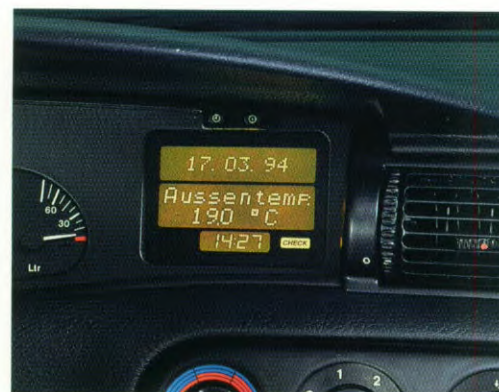
Info-display: naast tijd, datum en buitentemperatuur geeft dit display de functies van de boardcomputer en het Checkcontrol-Systeem weer.
