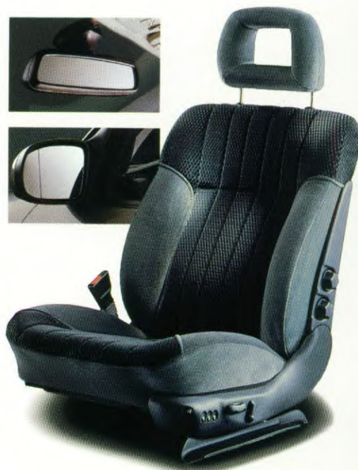
Deze elektrisch verstelbare bestuurdersstoel is in 8 standen verstelbaar en kan geprogrammeerd worden voor 3 individueel oproepbare zitposities, waarbij ook de binnen- en buitenspiegels automatisch in de gekozen stand draaien.
