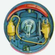
Twee remcilinders per voorwielrem verhogen de betrouwbaarheid.
