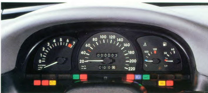
De nieuwe instrumenten zijn aangebracht achter wijzerplaten van lichtdoorlatende kunststof voor een duidelijk zicht, en waarborgen een gelijkmatige verdeling.
