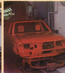
7 NAD: (Niet waterige dispersie). Acryllak met moffelthermoharding bij een temperatuur van meer dan 130°C. Sterke pantserlaag dank zij snel verdampende oplosmiddelen.
