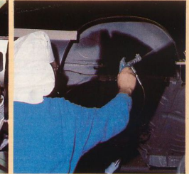
5 OVENGEGARDE PVC COATING: van 1 à 2 mm dik. Beveeligt carrosseriedelen die aan steenslag e.d. worden blootgesteld.
