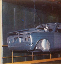
2 BEHANDELING MET IJZERFOSFAAT: Beschermert tegen stoten en bladderen, verhoogt alle onderdelen van de carrosserie. De holle delen zijn ontvet en gefosfateerd vóór de assemblage.
