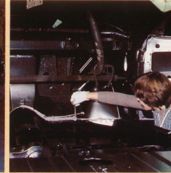
4 WASBEHANDELING: Door drukinspuiting in holle delen. Beschermert binnenwanden en voorkomt dat water tussen de plaatverbindingen dringt.
