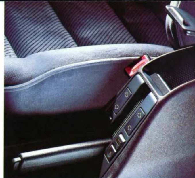
Tiptoetsen op de middenconsole voor de elektrisch bedienbare achterzijruiten
