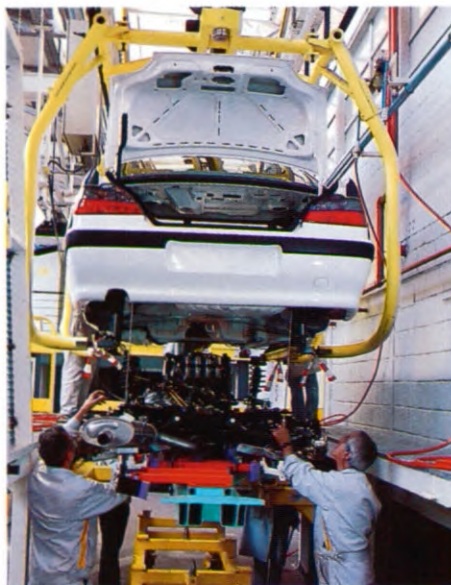
Laatste controle alvorens het mechanische gedeelte "samensmelt" met de carrosserie.
