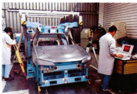
Controle van alle plaatwerkdelen, waarbij torsiestijfheidsmetingen worden uitgevoerd.
