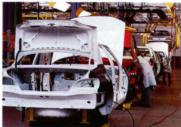
Minutieuze controle van de carrosserie. Dit gebeurt op vaste plaatsen van de assemblagelijne
