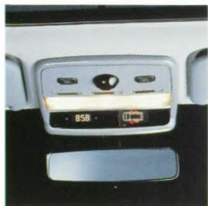
Plafondconsole met display niet goed gesloten portieren en tiptoetsen elektrisch bedienbare achterste zijruiten
