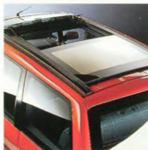
Meerprijs: panoramisch kanten/schuifdak; voorste deel handbediend kantelbaar, tweede deel elektrisch bediend schuifbaar.
