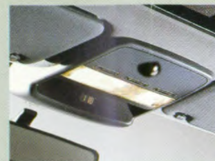
Plafondconsole met digitaal klokje en plafonnier.
