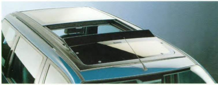
Meerprijs: panoramisch kanteel/schuifdak; vóór bandbediend kanteelbaar, achter elektrisch bediend schuifbaar.
