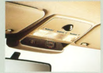
Plafondconsole met display niet goed gesloten portieren.
