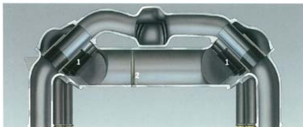
Varioram. Cilinderanzuigsysteem: schakelbuisverlenging (1) en resonantiekleppen (2) gesloten. Koppeloptimalisering bij lage en middelste toeren gebied.
