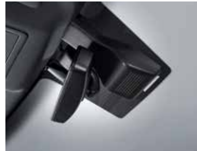
Naar voren gerichte cameramodule met regensensor en automatische koplampbediening
