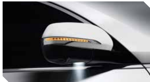
Richtingaanwijzers en grondverlichting zijn in de buitenspiegels ingewerkt.
