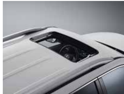
Elektrisch schuifdak met inklembeveiliging
