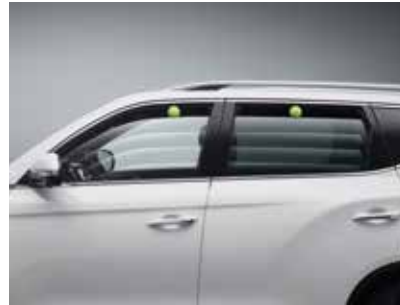
Elektrische ruiten met inklembeveiliging
