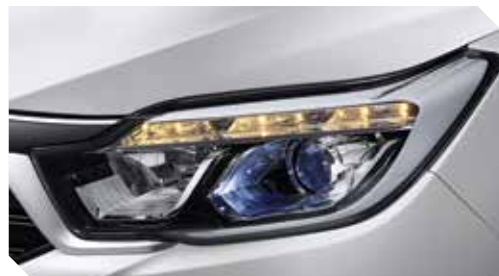
HID-koplampen voor een beter zicht 's nachts; De LED-dagrijlichten, parkeerlichten en richtingaanwijzers zitten samen bovenin het lichtblok voor een eenvoudige elegantie
