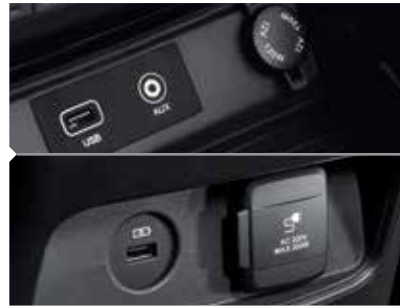
USB-poort en 12 Volt-stekker op middenconsole, USB-poort en 220 Volt-omvormer op 2 de zitrij
