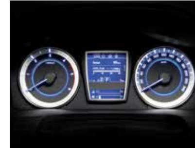
Instrumentenpaneel met boordcomputer en 3,5" TFT scherm
