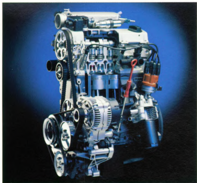
Sportief rijplezier met de 85 kW (115 pk) sterke 2,0 l motor. Met zijn maximum koppel van 166 Nm bij 3200 toeren beschikt hij over een uitstekende trekkracht.
