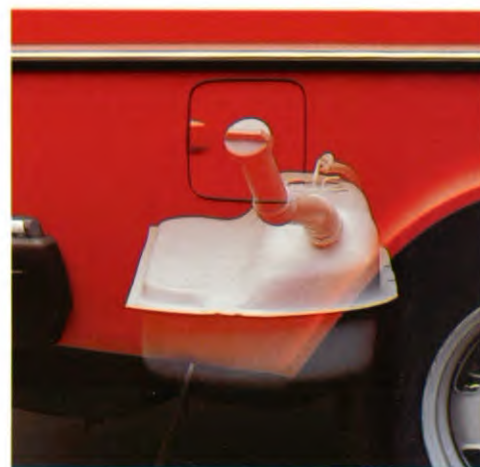
Goed beschermde brandstoftank.
