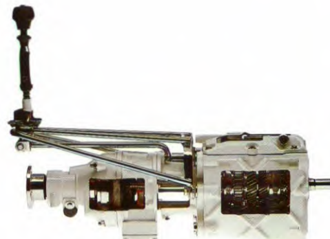
Vierbak met elektrisch bedienbare overdrive.
