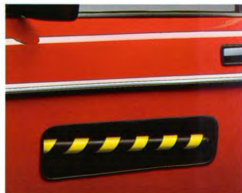
Stalen buizen in de portieren.
