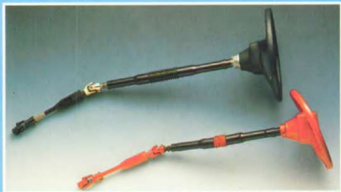
Samendrukbare stuurkolom met veiligheidsstuur.
