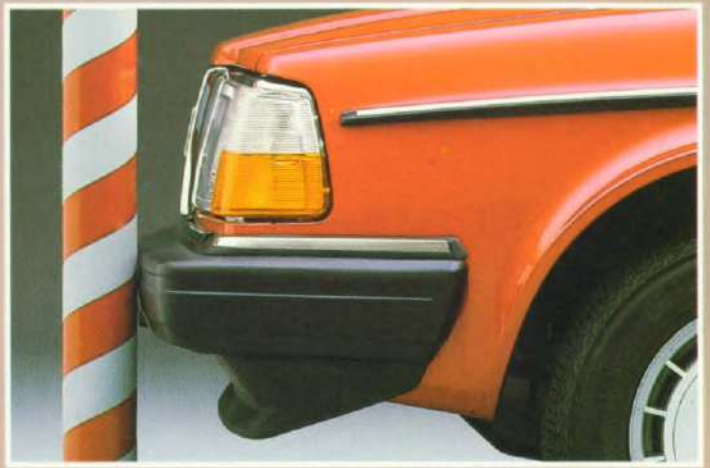
De bumpers kunnen bij aanrijdingen krachten absorberen tot snelheden van 4 km/u.
