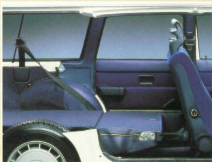
Verwijdering van de zitting geeft 15 cm meer laadruimte.
