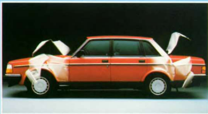
Kreukelzones vóór en achter absorberen zware krachten bij aanrijdingen, om passagiers te beschermen. De brandstoftank is veilig opgeborgen.
