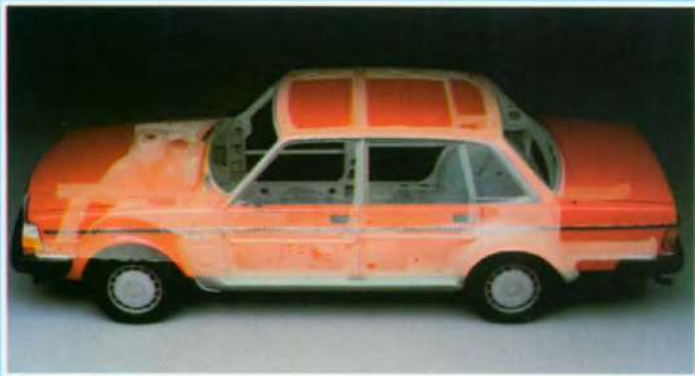
De sterke, stalen veiligheidskooi neemt de bescherming over, nadat de kreukelzones hun werk hebben gedaan.
