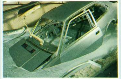
Onderdompeling in een cataforese-bad om de auto in de anti-roest-primer te zetten.
