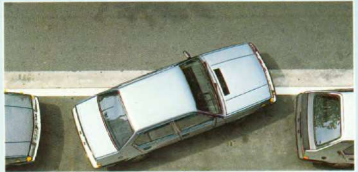
Kleine draaicirkel om gemakkelijk te parkeren. Draaicirkel 1.7-liter-, 2.0-liter en Diesel-modellen 9.35 m; 1.4-liter modellen 9.20 m.
