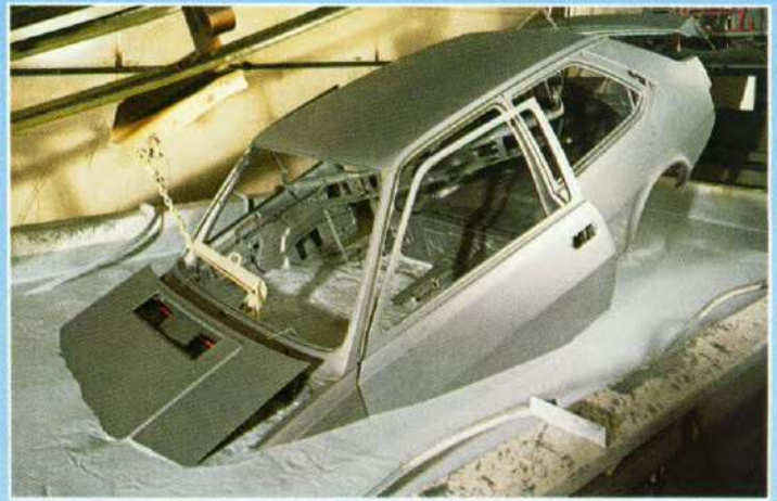
Onderdomping in een cataforese-bad om de auto in de anti-roest primer te zetten.
