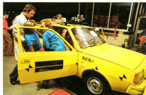
De dummies worden in de auto's geplaatst en zijn verbonden met apparatuur die zeer nauwkeurig registreert welke reacties de botsing teweegbrengt.
