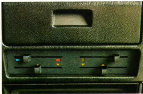
De bediening van ventilatie en verwarming bevindt zich centraal op het dashboard en is te regelen door schuifknoppen.
