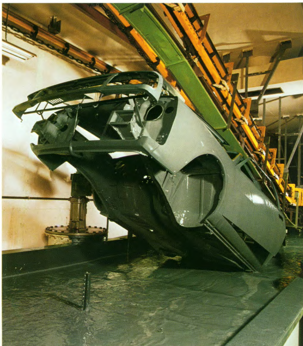
De gehele onderkant wordt voorzien van een elastische bitumen beschermingslaag en de drempels worden tegen steenslag beschermd door een sterke PVC-laag.
