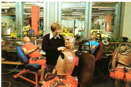
In het testcentrum worden de dummies klaargemaakt die worden gebruikt bij de botsproeven. De dummies zijn zo getrouw mogelijke kopiën van het menselijk lichaam.
