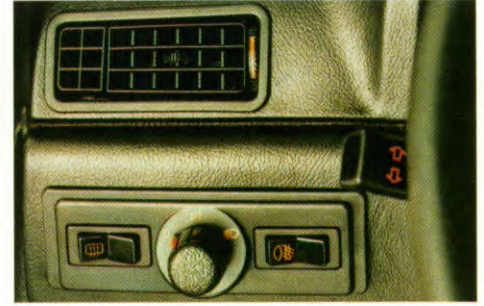
Links naast het stuur: regelbare luchtinlaat, draaiknop voor gedimd licht en stadslicht en tuimelschakelaars voor achterrauitverwarming en mistachterlicht.
