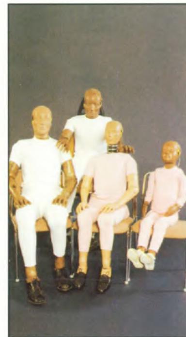
Volvo gebruikt elektronische dummies - van verschillende lichaamsgewichten en -afmetingen - om precieze resultaten te verkrijgen bij gesimuleerde botsingen.
