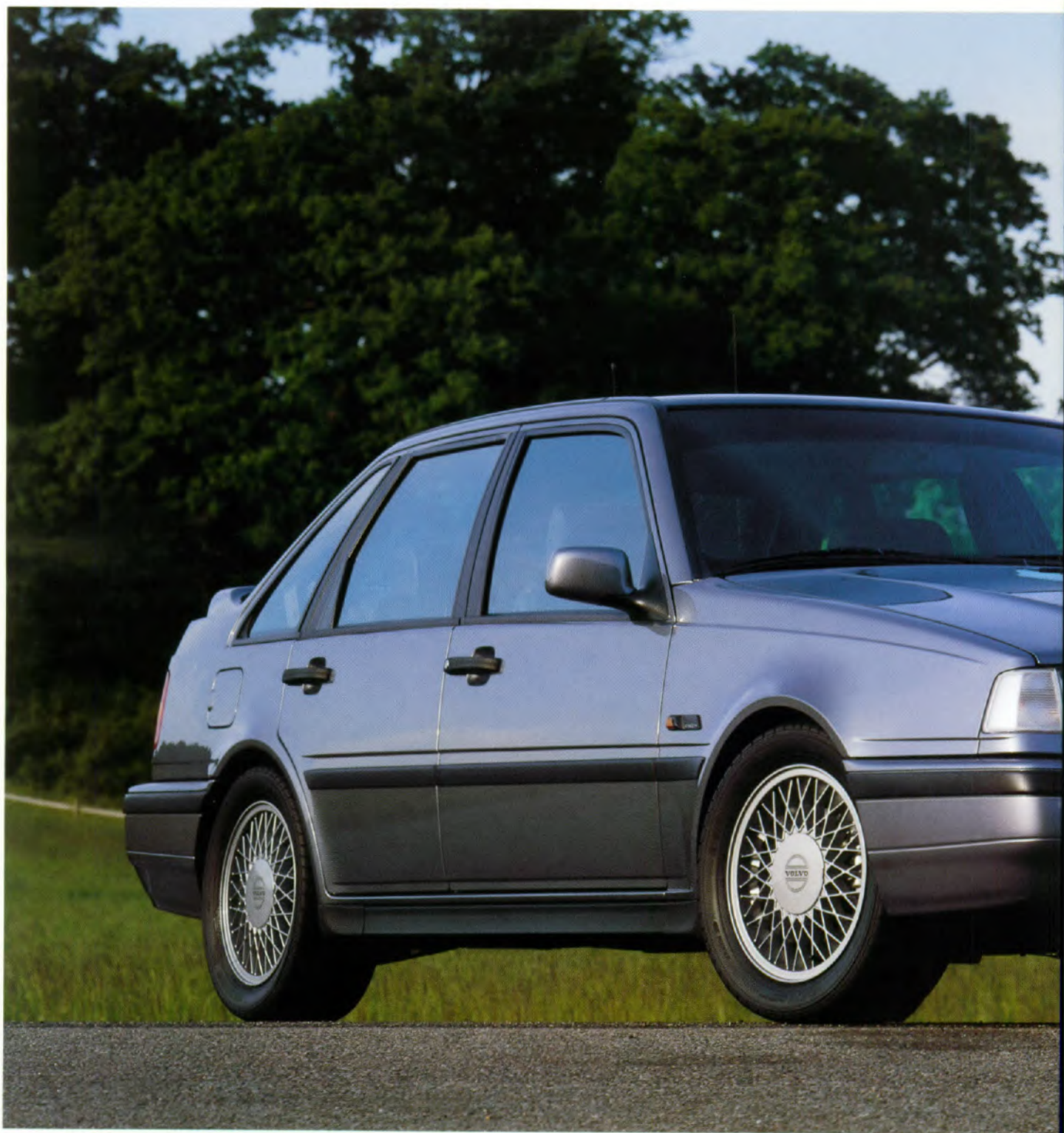
De op de foto afgebeelde Volvo 440 GLE is uitgerust met lichtmetalen Vesa-velgen, achterspoiler, koplampen met wissers en sproeiers, mistlampen, antenne en beschermrek.
