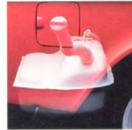
1974 Geïsoleerde vervorm- bare brandstoftank
