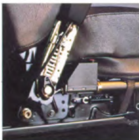
De automatische gordelaanspanner op de voorstoelen spant bij een botsing de gordel in slechts 25 milliseconde aan.
