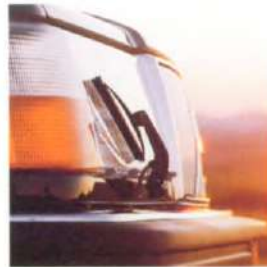
1973 Koplamp Wis/Was installatie
