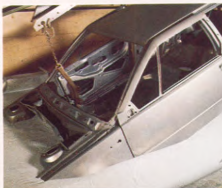
Elektro-dompelbad met primer, voor totale roestbescherming.
