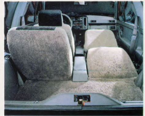
Het met één hand veranderen van het passagierscompartiment in drie verschillende bagageruimtes.
