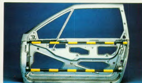
Twee balken in ieder portier voor extra veiligheid.
