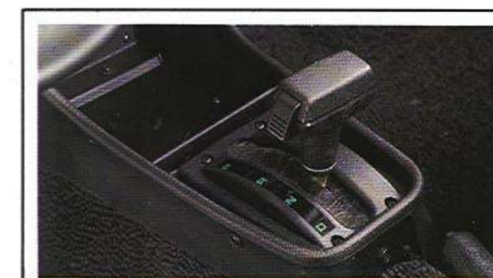
De keuzehendel kent 4 posities. Om veiligheidsredenen hebben de standen P (parkeren) en R (achteruit) een speciale vergrendeling. Bovendien zijn de letters verlicht.
