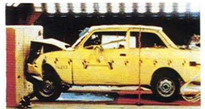
Het passagierscompartiment van de Volvo 66 is omgeven door een oerdegelijke kooiconstructie.
