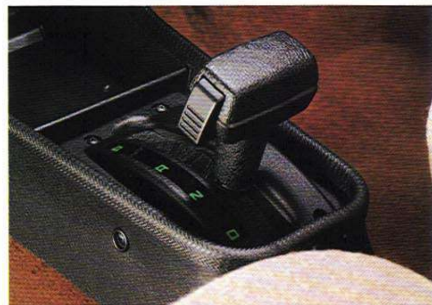
N - neutraal, D - vooruit, R - achteruit, P - parkeren (de transmissie is geblokkeerd)
