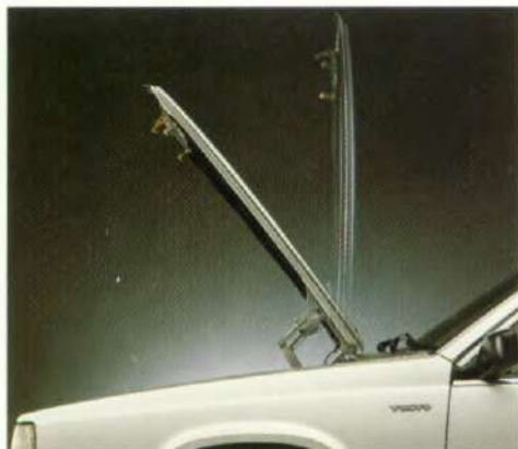
De motorkap kan in twee standen open, voor 'n betere toegankelijkheid.
