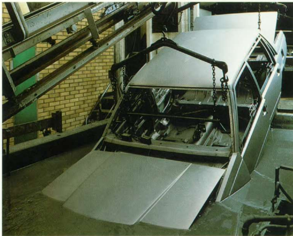
Roestbescherming door onderdompeling in een elektrolysebad.
