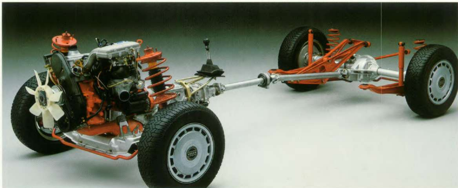
Schijfremmen rondom. Tandheugelstuurinrichting. McPherson veerpoten vóór en de achteras met het unieke subframe, zorgen voor 'n uitstekend rijcomfort en 'n voortreffelijke wegligging.
