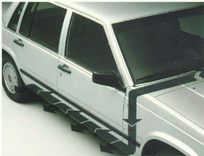
Dit is een Volvo specialiteit . . . geventileerde dorpels voorkomen roest van binnenuit.
