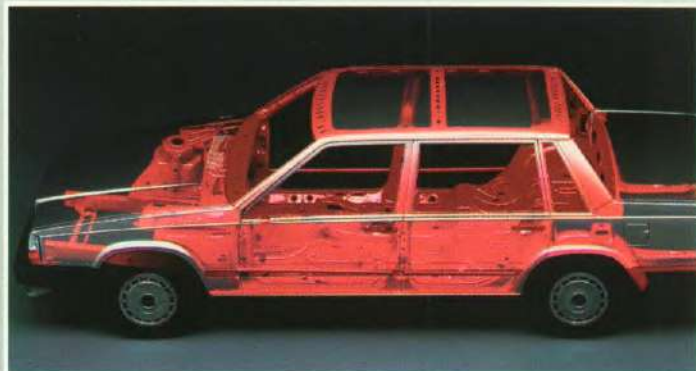
De sterke stalen veiligheidskooi neemt de bescherming over, nadat de kreukelzones hun werk hebben gedaan.
