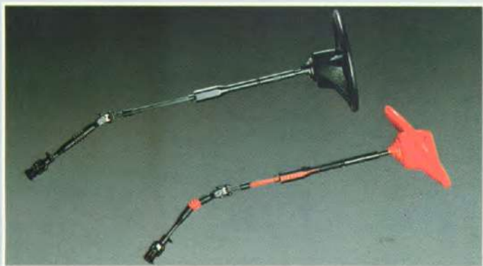
Samendrukbare stuurkolom met veiligheidsstuurwiel.
