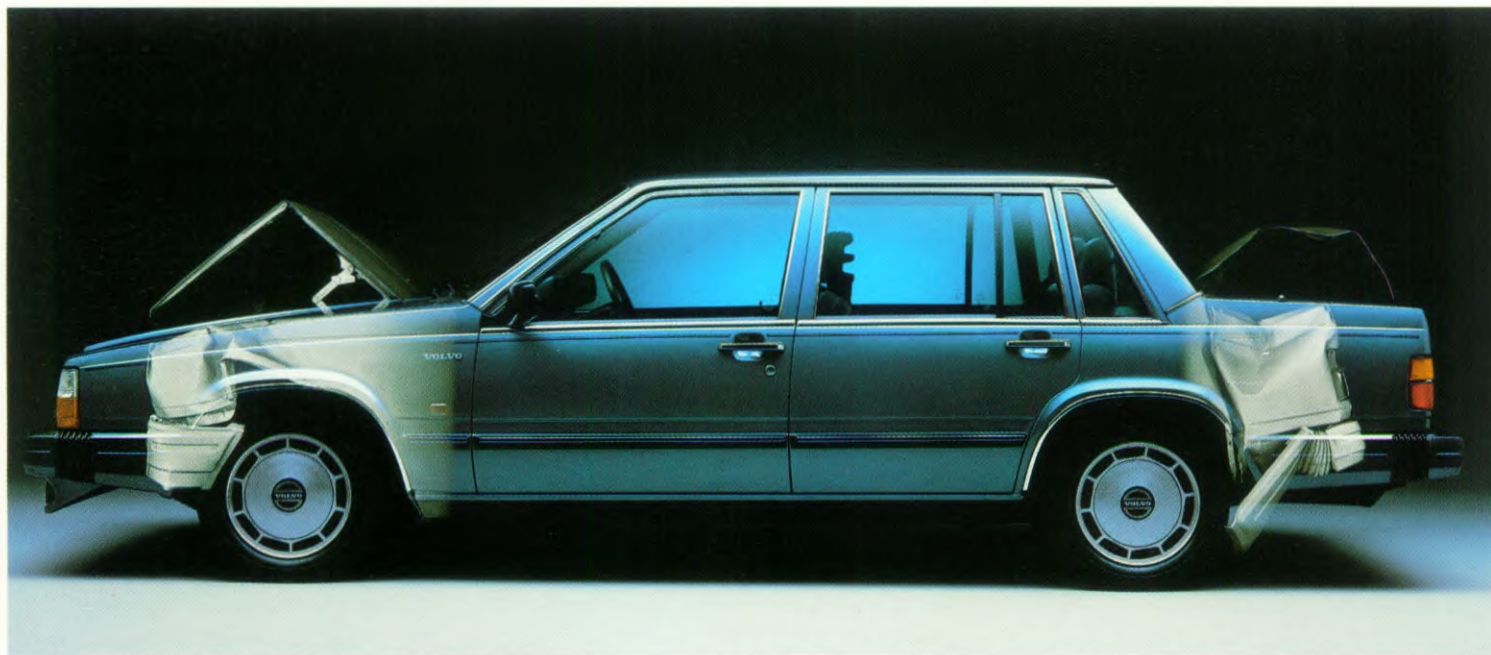
Eersteklas bescherming: energie-absorberende kreukelzones en een sterke stalen veiligheidskooi.
