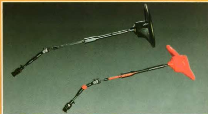
Samendrukbare stuurkolom met veiligheidsstuurwiel.
