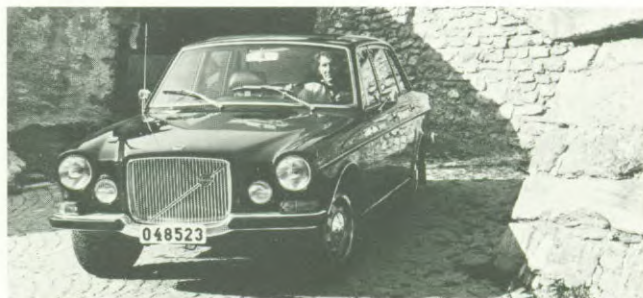
De Volvo 164 werd in 1968 gepresenteerd. Een fraaie, representatieve wagen met o.a. leren bekleding. De zes-cilinder motor leverde een vermogen van 145 pk. (Volvo 164. 1968–75).
