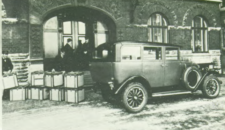
Met het chassis van de Jakob als basis werd een gesloten uitvoering gemaakt. De carrosserie was bekleed met pegamoid, een soort kunstleer. Als extra kon op deze auto bumpers worden geleverd. (PV 4, 1927 – 1929).
