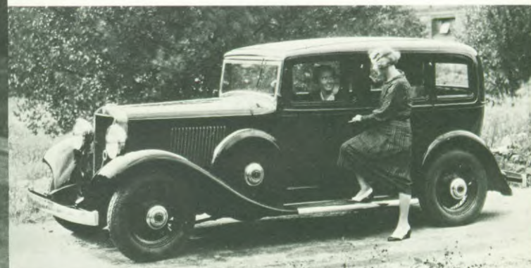
Een werkelijk luxueuze wagen. Drie versnellingen met een zes-cilinder motor van 3,27 liter. Automatisch werkende achteruitrijlichten was iets bijzonders. (PV 653-654, TR 676-679, 1933 – 1935).
