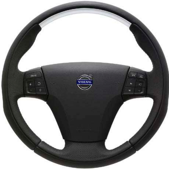
Met leder bekleed sportstuurwiel afgewerkt met aluminium inleg
