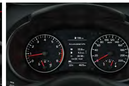
Nytt digitalt 4,2" Supervision-instrumentpanel LCD-skjermen viser kjøredata og viktig informasjon om bilens status, slik at du alltid har full oversikt.
