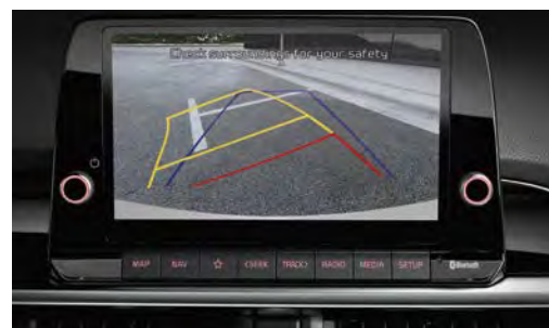
Ryggekamera med dynamiske hjelpelinjer Ryggekameraet hjelper deg å rygge inn i en parkeringsluke. Området bak bilen vises på bilens 8" skjerm sammen med dynamiske hjelpelinjer.
