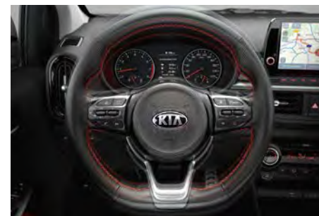
Motorisert servostyring (MDPS) med vipbart ratt Gjør det lettere å svinge. Rattstammen kan vippes opp, slik at det blir enkelt å komme seg inn i og ut av bilen
