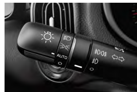
Automatisk lysregulering Sett lyshendelen på Auto, så slår front- og bak-lysene seg på og av avhengig av lysforholdene.
