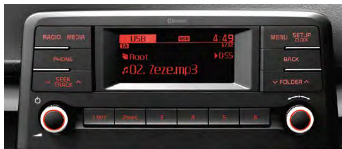
Lydanlegg Det kompakte 3.0-lydanlegget med RDS og DAB-radio har monokrom TFT-LCD-skjerm og fem høyttalere. Du kan også koble til bærbare enheter via en USB-port.
