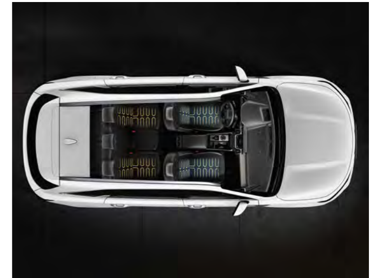
SETER MED VARME OG VENTILASJON
