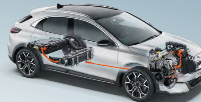
Grafisk fremstilling av motor/batteri i Plug-in Hybrid.
