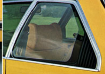
Lufteventiler på siden sørger for stadig gjennomstrømming av frisk luft i kupéen.
