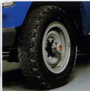
205 SR16 radialdekk er standard. Dette er et kombinasjonsdekk med gode egenskaper sommer som vinter — i terrenget eller på vei.
