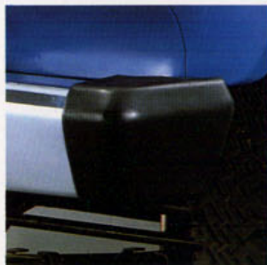
Solide støtfangere med hjørnebeskyttere i vinyl.
