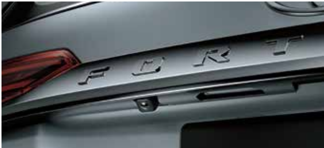
Cámara de retroceso: Le ayuda cuando tiene que retroceder para aparcar en un ángulo de 90 grados o en paralelo, mostrando la vista posterior tomada por una cámara integrada en la parte trasera del vehículo. *3
