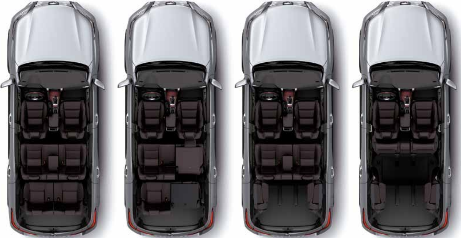
Disposición de los asientos: Su espacio interior puede adaptarse rápidamente a diversas combinaciones de personas y mercancías. Es sencillo y rápido plegar los asientos de la segunda fila para facilitar el acceso a la tercera fila de asientos. Para ampliar el espacio con el fin de colocar mercancías grandes o largas, los asientos de la segunda fila se pueden plegar y los de la tercera se pueden colocar para que no ocupen espacio utilizando ganchos fijos fáciles de alcanzar.
