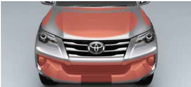
Estructura de la carrocería para ayudar a reducir las lesiones de los peatones: Las medidas amortiguadoras de impactos incluyen el paragolpes delantero, el capó, la rejilla y los soportes de los guardafangos delanteros.
