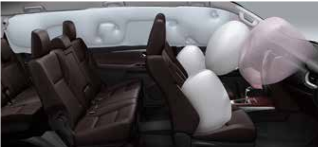
Bolsas de aire (“Airbags”): El Fortuner está equipado con cojín de aire SRS (sistema suplementario de sujeción) para el conductor, cojín de aire SRS para el pasajero delantero, cojín de aire SRS para las rodillas (asiento del conductor), cojines de aire laterales SRS (asientos delanteros) y cojines laterales SRS tipo cortina (asientos delanteros y traseros). *2
