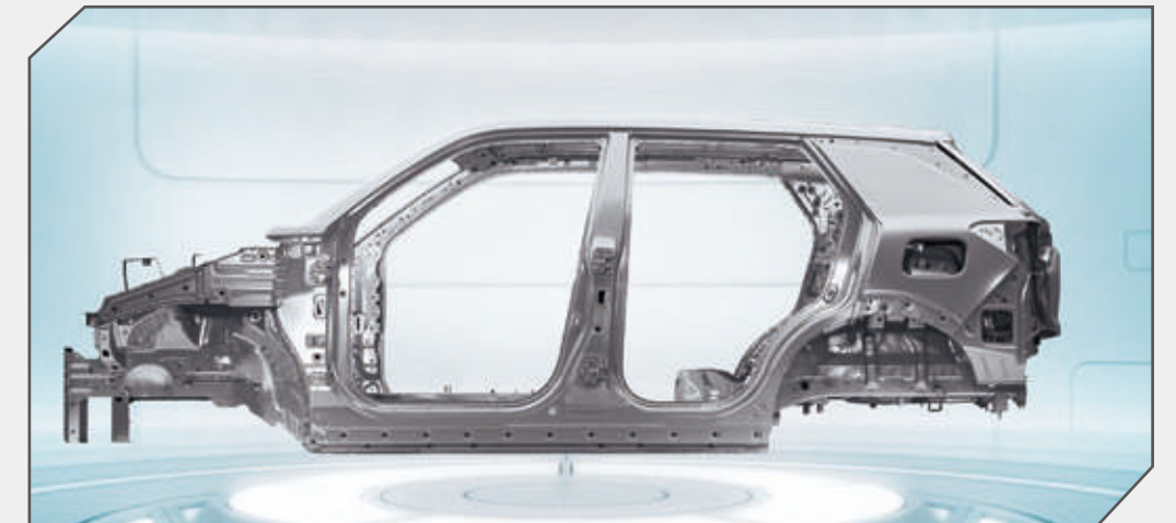
Carrocería reforzada con 74% de acero de alta resistencia
