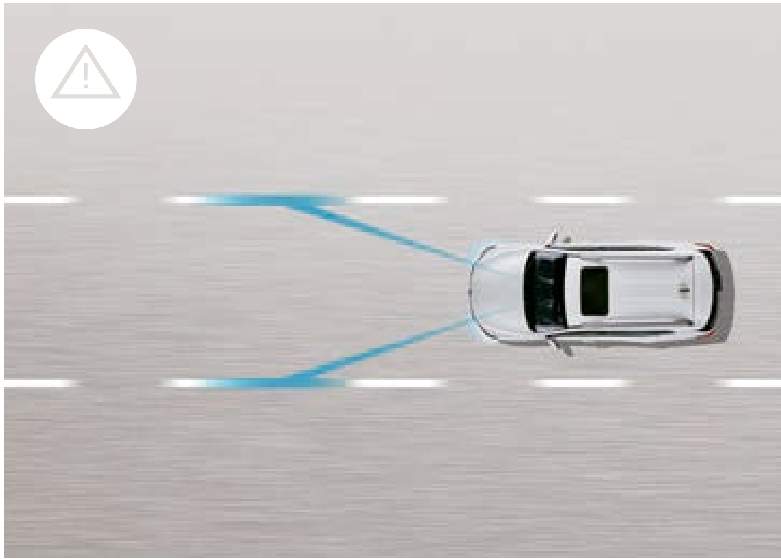
Sistema de aviso de pérdida de carril (LDWS) Este sistema envía una señal audible y gráfica en el tablero cada vez que se reduzca el nivel de atención del piloto y corra el riesgo de salir del carril.
