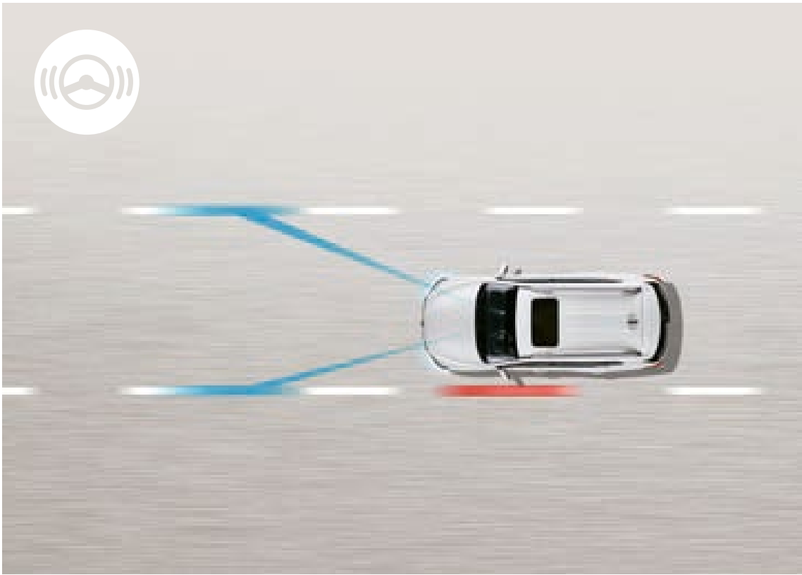
Sistema de mantenimiento de carril (LKAS) Gracias a este sistema el volante opera automáticamente para que cada vez que el vehículo comience a desviarse del carril este lo centre y mantenga su posición. Esto siempre y cuando no se haya activado ninguna direccional de giro.
