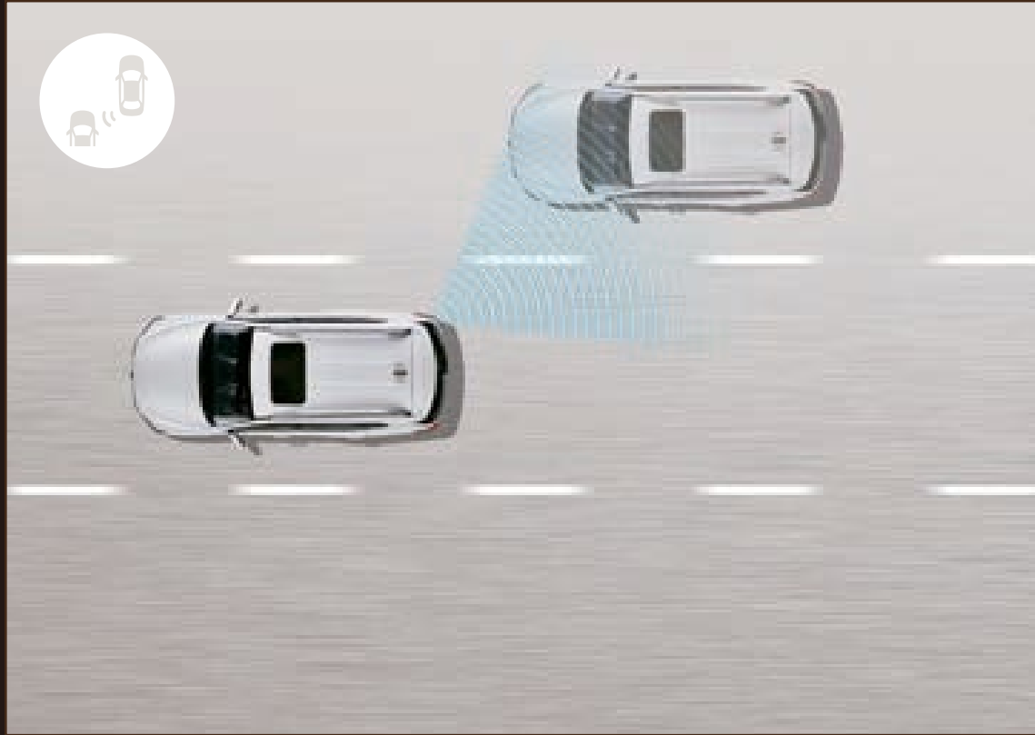
Sistema de aviso de punto ciego (BSD) Gracias a este sistema, tendrás una advertencia audible y también visual en tablero y espejos, al momento de colocar las direccionales con la finalidad de saber si hay un vehículo a tu lado que pueda ocasionar una colisión.
