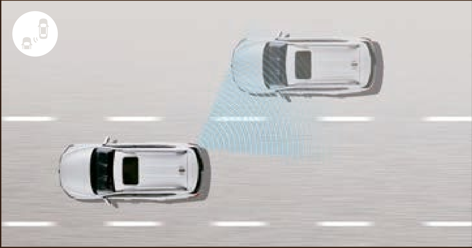
Sistema de aviso de punto ciego (BSD) Gracias a este sistema, tendrás una advertencia audible y también visual en tablero y espejos, al momento de colocar las direccionales con la finalidad de saber si hay un vehículo a tu lado que pueda ocasionar una colisión.
