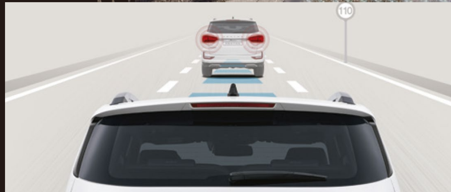
Señal de parada de emergencia
