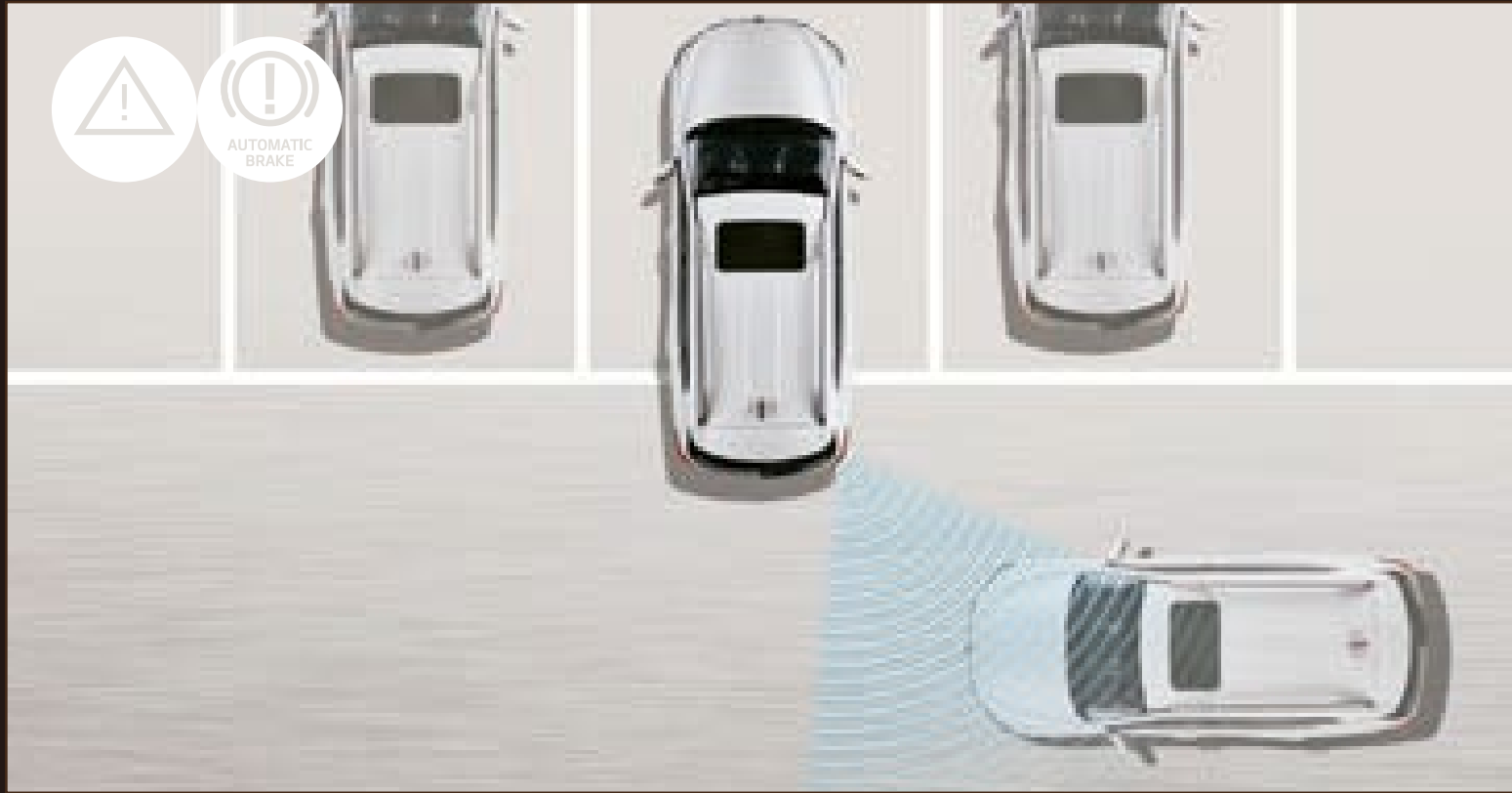
Asistente de colisión de tráfico cruzado (RCTA) Cuando el vehículo está retrocediendo, este asistente se activa y de haber otro vehículo aproximándose, envía una señal audible.
