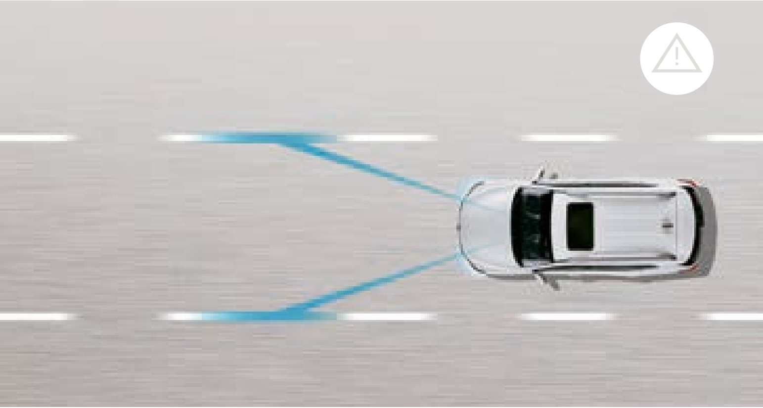
Sistema de aviso de pérdida de carril (LDWS) Este sistema envía una señal audible y gráfica en el tablero cada vez que se reduzca el nivel de atención del piloto y corra el riesgo de salir del carril.
