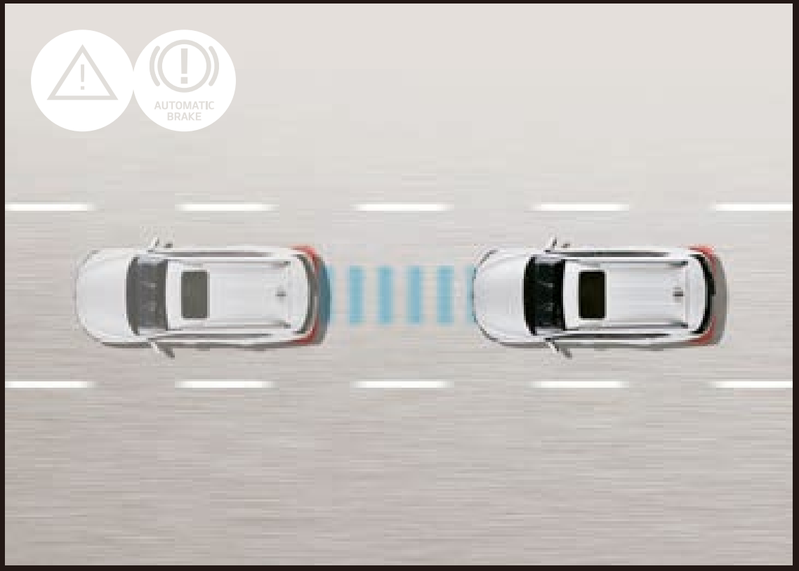
Sistema autónomo de frenado (AEBS) El sistema AEBS puede lograr detener el vehículo en caso detecte que el conductor no está alerta en el manejo ante una colisión inminente.
