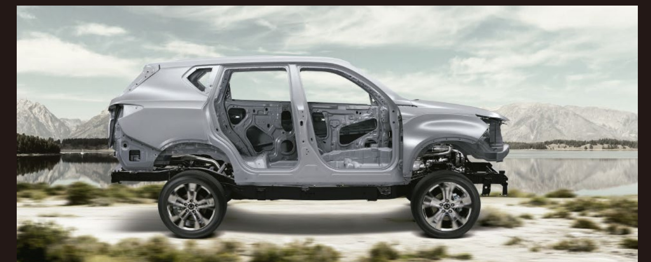
Carrocería reforzada con acero de alta resistencia en 81.7%
