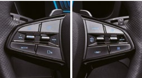
Przełączniki radia oraz tempomatu na kole kierownicy
