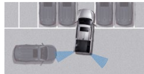
Radar ruchu poprzecznego z tyłu pojazdu (RCTA)
