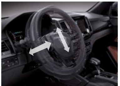
Regulacja pochylenia kolumny kierownicy w obu kierunkach
