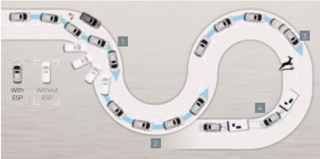
1. ESP - system dynamicznej kontroli toru jazdy 2. ARP - system aktywnej ochrony przed dachowaniem 3. BAS - system wspomagania hamowania awaryjnego 4. Kontrola kołysania przycze- py - stabilizuje odchylenia i kołysanie ciągniętej przycze- py
