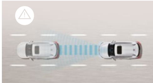
SDW - Asystent utrzymania odległości od pojazdu poprzedzającego
