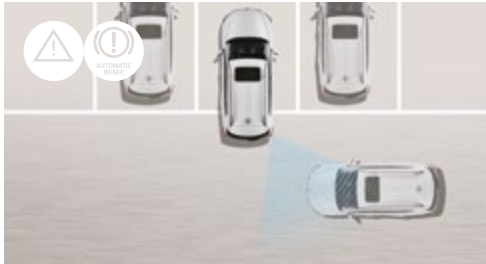
RCTA - Radar ruchu poprzecznego z tyłu pojazdu
