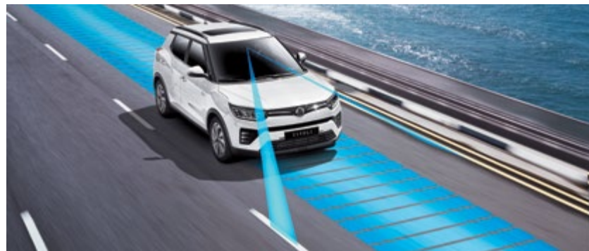
System ostrzegania o niezamierzonej zmianie pasa ruchu (LDW). Powiadamia kierowcę dźwiękiem, gdy moduł kamery przedniej wykryje niezamierzone zjechanie z pasa ruchu (bez uprzedniego włączenia kierunkowskazu).
