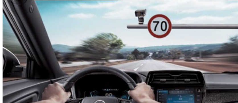
System rozpoznawania znaków drogowych (TSR). Wyświetla informacje o znakach drogowych, do których się zbliża pojazd, m.in. znaki ograniczenia prędkości. W ten sposób system maksymalizuje bezpieczeństwo jazdy.
