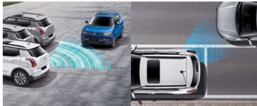
Funkcja wspomagania przy wyjeździe z miejsca postoju (EAF). Jeśli podczas wyjeżdżania z miejsca parkingowego, inny pojazd zbliża się z tyłu pojazdu, system EAF włącza alarm i wyświetla ikonę ostrzeżenia.
