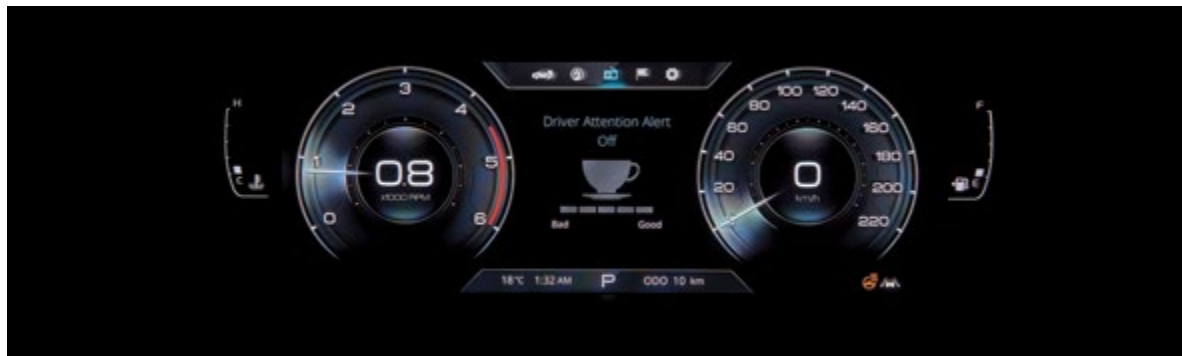
Asystent zmęczenia kierowcy (DAA). Styl jazdy jest stale monitorowany i gdy tylko wykryta zostanie senność/nieuwaga kierowcy, DAA ostrzeże dźwiękowym sygnałem alarmowym i zaleci przerwę w prowadzeniu.
