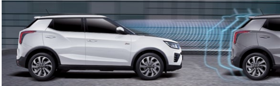
Alert sprawnego ruszania (FVSA). Ostrzega komunikatem wizualnym i alertem dźwiękowym w chwilę po tym, jak ruszy pojazd z przodu.
